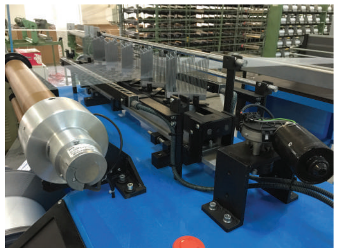
Peine en zig-zag, entrada hilo al plegador Zigzag reed, yarn entrance up to the beam
