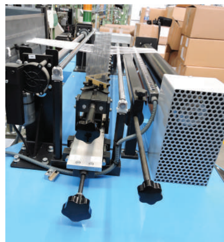
Peine de entrada y peine de cruces Inlet reed and leasing device
