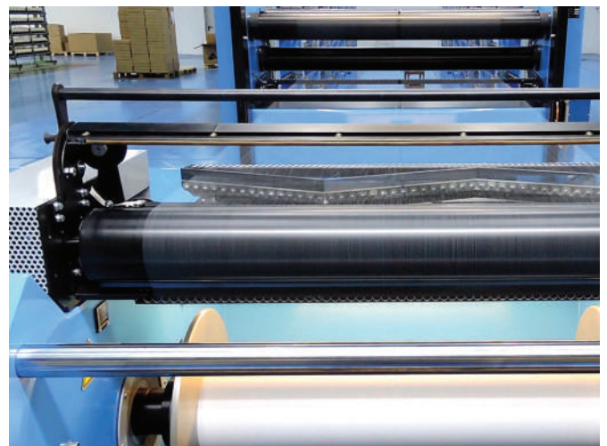
Peine de entrada hilo al plegador, con rodillo y prensa final del plegador Inlet reed, with roller and pressing device
