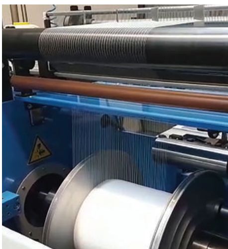
Rodillo de entrada al plegador Inlet roller
