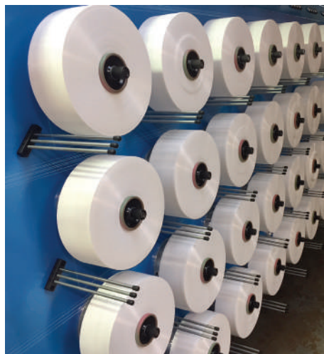
Portaconos fijación bobinas Cone holders to fix the bobbins
