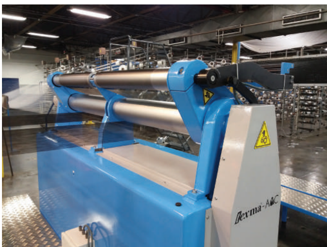
Parte trasera 50" motorizada Motorized 50" backside group
