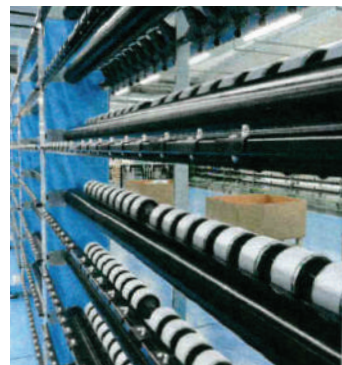
Guía hilos elastómero GRE. Threads guide for elastomeric yarn GRE.
