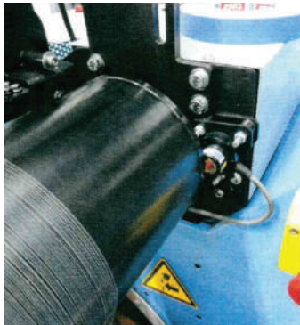
Laser stop para elastómero. Laser stop for elastomeric yarn.
